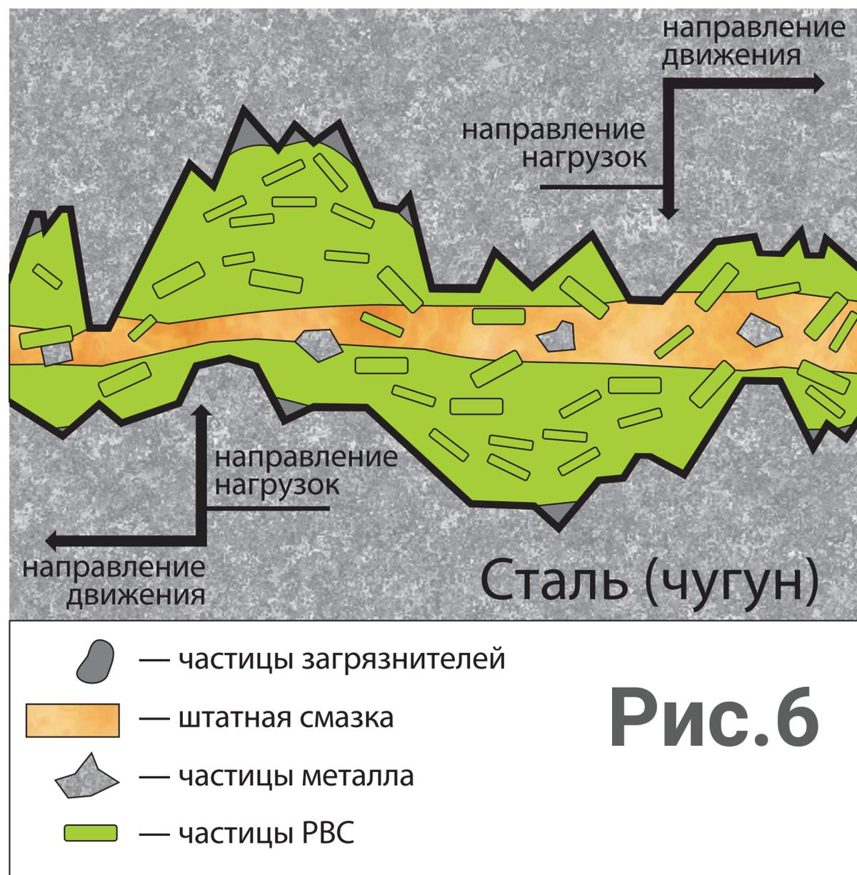
**В результате механического уплотнения поверхности:**
