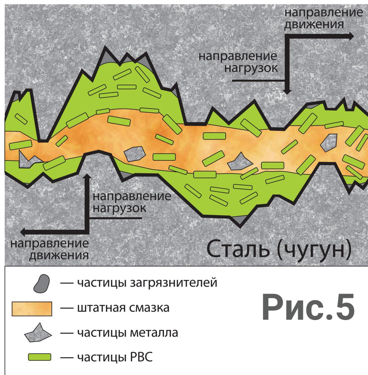
В каждой точке поверхности трения электромагнитные микрополя выстраивают микро-частицы PVC в определенном порядке. Абсолютная спаянность обеспечивает восстановление сил взаимодействия частиц. А выступы микрорельефа поверхностей трения при контакте еще и уплотняют частицы материала.
